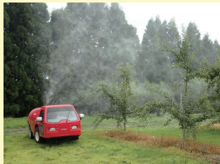
スピードスプレーヤーの片側散布 (片側散布の際、ドリフトしないように遮風板を併用)
