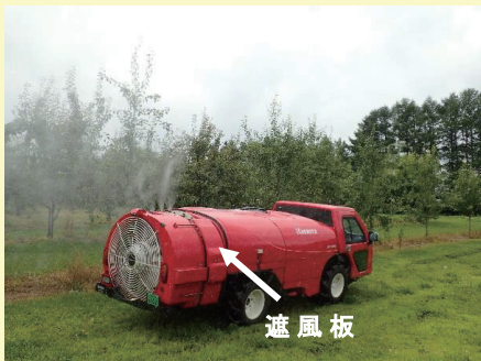
スピードスプレーヤーの片側散布 (片側散布の際、ドリフトしないように遮風板を併用)
