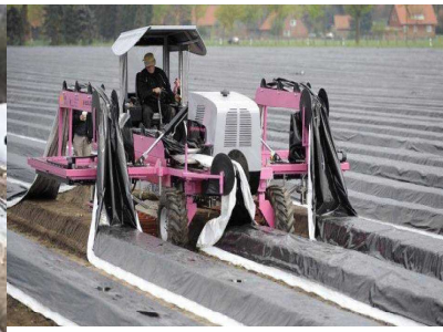
アスパラの被覆ビニールの除去に機機を導入
