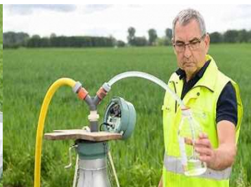
地下水の硝酸塩汚染の 定期調査
