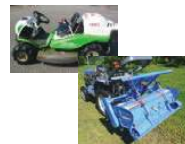
粉碎後に中耕すき込み処理 時速3kmで粉碎後、時速2~2.5kmで中耕(30分/10a→45~60分/10a)。各1回ずつ
