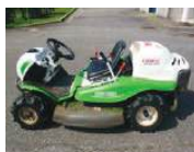
乗用草刈機による粉碎処理 時速2.5km(45分/10a)で2回
